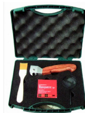
Zestaw noży krążkowych o rozstawie 1 2 i 3 mm
